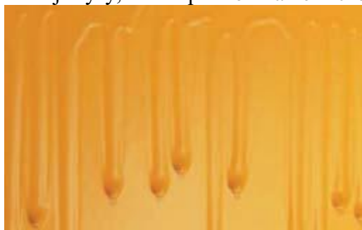
Zacieki na powłoce lakierniczej
